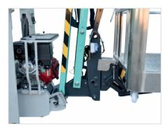
Compattezza del gruppo jib che ospita la cella di carico e sistema di montaggio rapido del cestello.
