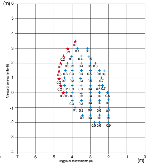
Sollevamento laterale, con carro chiuso, con braccio standard
