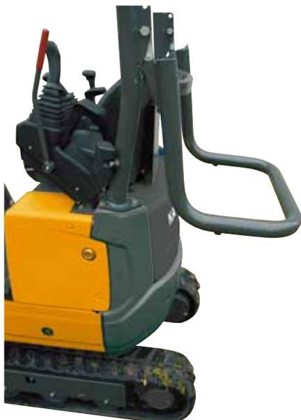
L'HD12VXE è in grado di oltrepassare una porta con luce minore di 90 cm. Inoltre si può smontare il rollbar in pochi minuti per facilitare passaggi sotto altezze minime.
