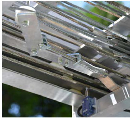
sistema di sicurezza rottura fune
