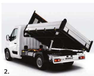
1. Impianto di sollevamento elettroidraulico. 2. Cassone ribaltabile trilaterale
