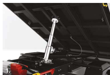
1. Impianto di sollevamento elettroidraulico. 2. Cassone ribaltabile trilaterale
